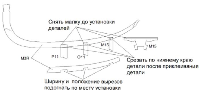
6.29. Подгоните положение верхнего ригеля в соответствии с рисунком справа и Рис. 68, 69 фото инструкции. Передний конец ригеля необходимо подогнать по месту так, чтобы его деревянная часть лежала встык с княвдигедом, а латунная накладка 8 лежала встык с накладкой 20 как на Рис. 68 и на обложке фото инструкции. Для плотного прилегания ригеля к корпусу подрежьте верхний шерстрек и планширь спереди кат-балки (Рис. 51, 52).
